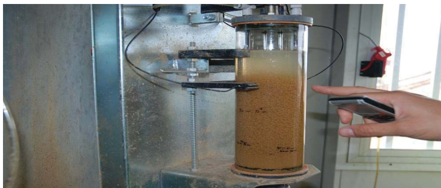
Système de régulation du dosage de flocculants dans un circuit de lavage de granulats
